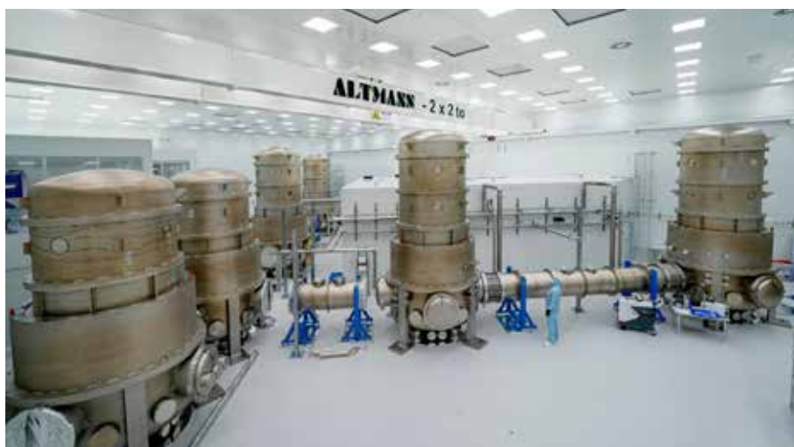
Figuur 2. Het ETPF-lab in Maastricht. De optica wordt trillingsvrij opgehangen in de torens, die met elkaar verbonden zijn door vacuümbuizen. De torens zijn minder hoog, omdat de spiegels kleiner zijn dan die gepland in de ET. (Afbeelding: ETpathfinder Team)
