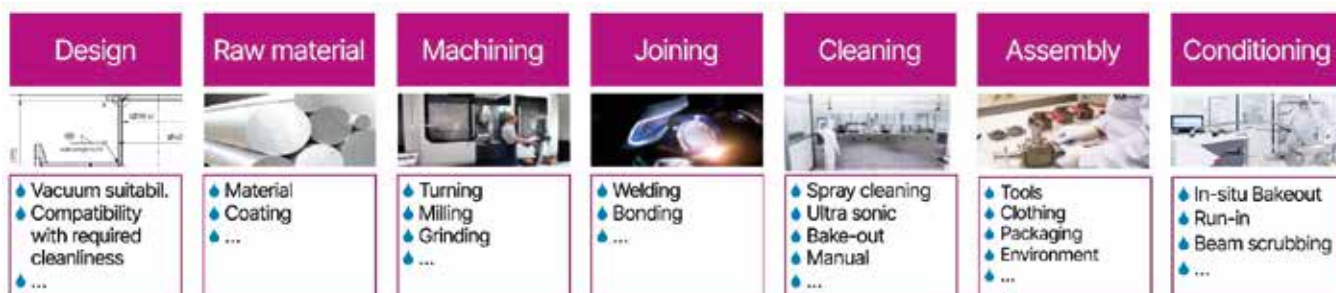
Figuur 2. Typische processtroom voor het realiseren van UCV-componenten vanuit het perspectief van de fabrikant.
