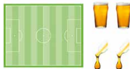
Figuur 1. Componenten direct afkomstig van de mechanische productie kunnen een typische filmische verontreiniging hebben van 1 \cdot 10^{-5} \text{ g/cm}^2 . Na hoogwaardige reiniging kan deze waarde worden teruggebracht tot 3 \cdot 10^{-9} \text{ g/cm}^2 . Dit komt overeen met het verschil tussen het uitsmeren over een voetbalveld van twee glazen bier dan wel twee losse druppels bier.
