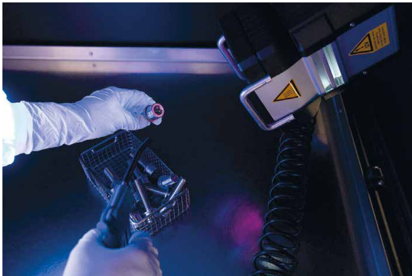
Figuur 5. Kwaliteitscontrole op deeltjesverontreiniging door black-light -inspectie bij VACOM. Resterende deeltjes zullen onder deze omstandigheden oplichten.
