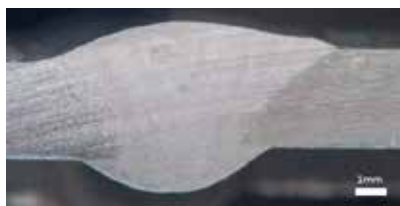
Figuur 4. Dwarsdoorsnede van twee lasnaden. Links een vacuümcompatibele lasverbinding, die wordt bewaakt door een geschikt procesbewakingssysteem. Rechts diverse holtes en lasinsluitingen, die bij de toepassing tot uitgassing leiden (virtueel lek).
